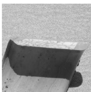
نمونه واقعی مواد بیرون آورده شده از اکسترودر و سطح مقطع آن
